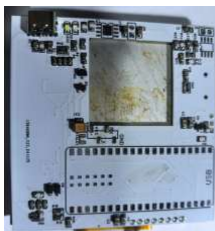
图 5.8.2 回流焊第一阶段
